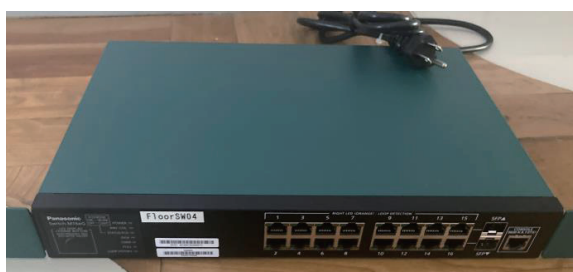
図 8 新しく設置された基幹ハブ（Panasonic 製品）
